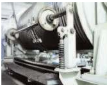
↑ Seilandrückvorrichtung zum sicheren Wickeln der Hubseile
