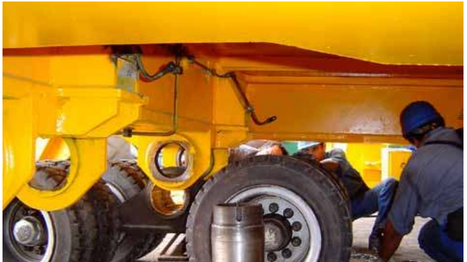
↑ Reparatur der Pendellagerung der Hinterachse
