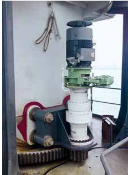
↑ Neue konstruktive Lösung der Drehwerkskonsole als Befestigung
